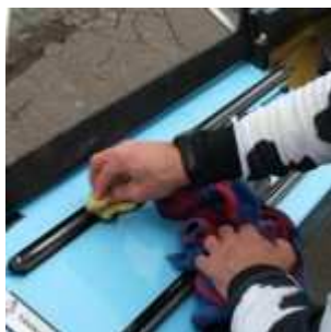
Mit Schwamm oder Tuch die Rollbahn gründlich reinigen
